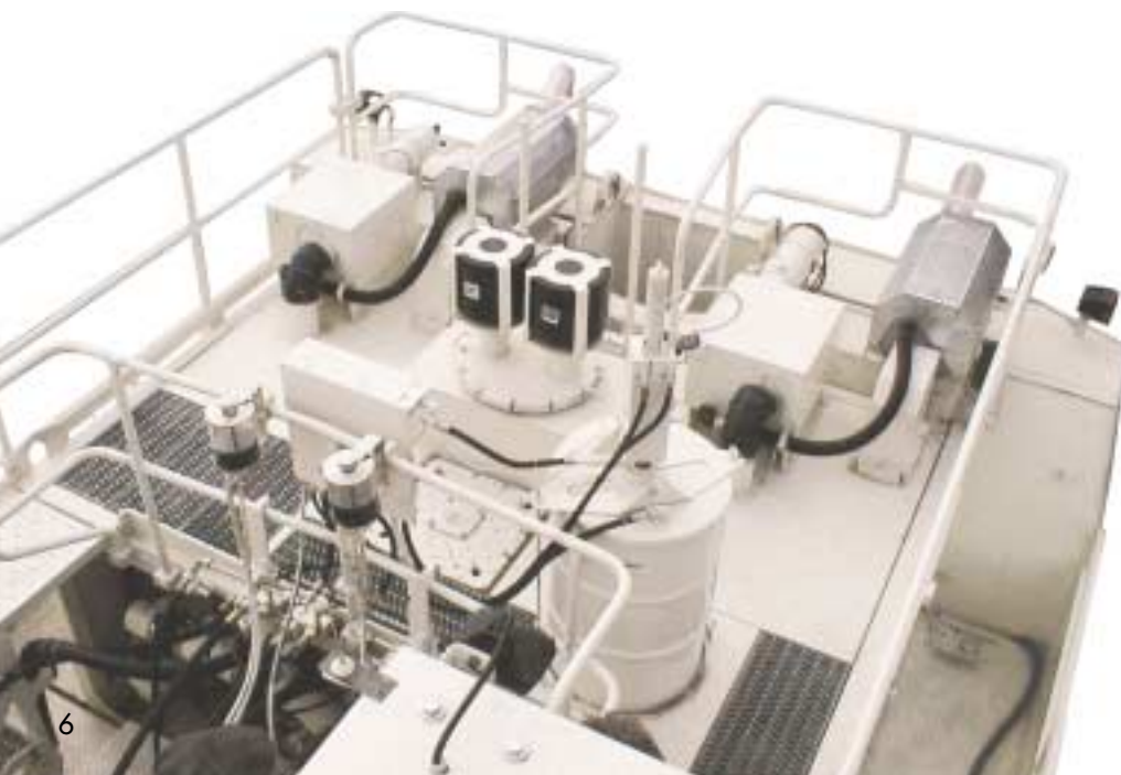
Una instalación de repostamiento que se acciona hidráulicamente está ensamblada debajo del contrapeso. Las pausas para repostamiento y mantenimiento se reducen a un mínimo por ser muy fácil el relleno de los combustibles.
