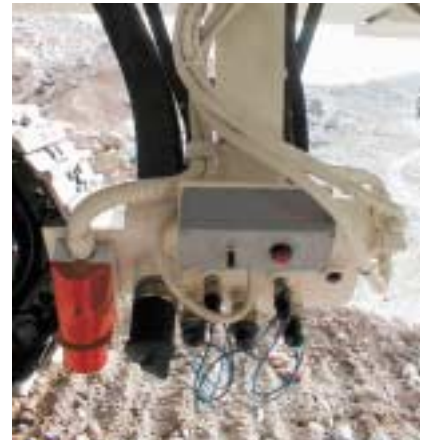
Una instalación de repostamiento que se acciona hidráulicamente está ensamblada debajo del contrapeso. Las pausas para repostamiento y mantenimiento se reducen a un mínimo por ser muy fácil el relleno de los combustibles.
